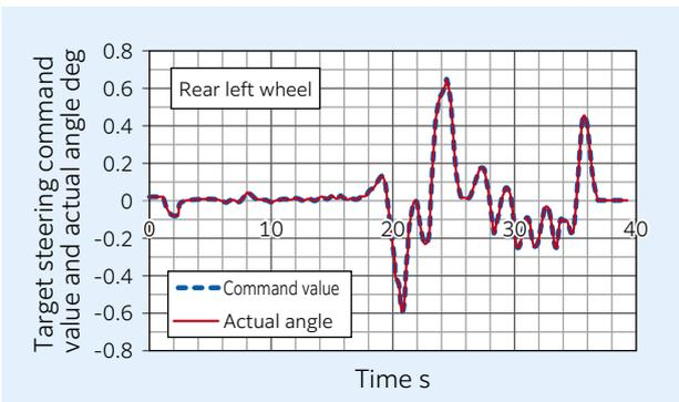
**Fig. 17** Ra-sHUB command value and actual angle
