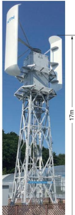
Fig. 11 10kW Wind Turbine
