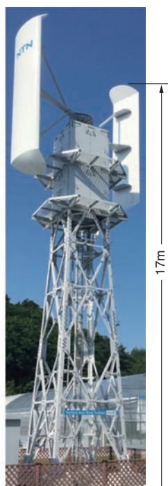
図11 10kW機 10kW Wind Turbine
