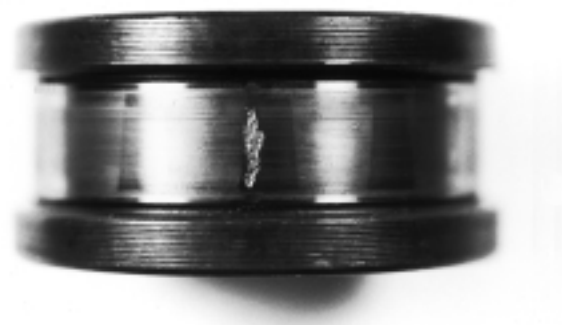
図4 はく離の観察例（試験C, 1.32 \times L_{10h} ） Example of flaking (Test C, 1.32 \times L_{10h} )
