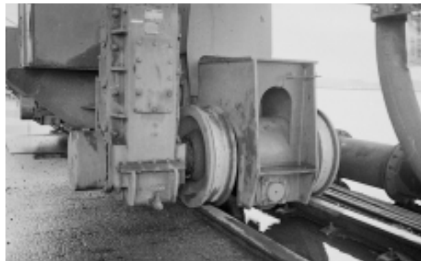
写真2 アンローダ車輪部 (石川島播磨重工業株式会社殿 提供) Wheels of unloader (by Ishikawajima-Harima Heavy Industries Co., Ltd.)
