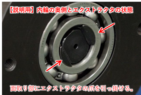
図 5.33 エキストラクタの固定状態(説明用)
