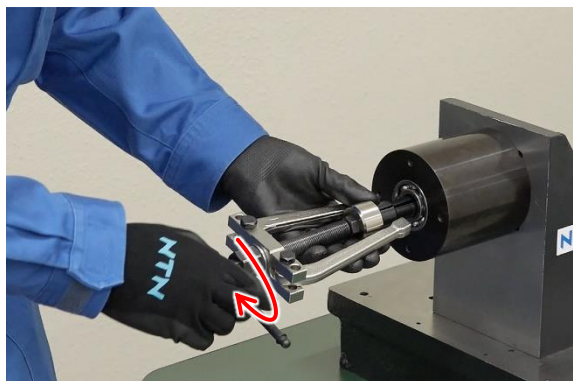
図 5.39 アームの取付け
