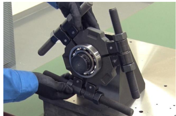
図 5.16 プレートをねじで固定
