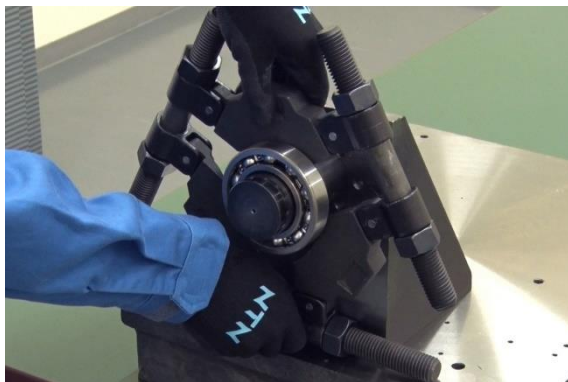
図 5.15 プレートの取付け
