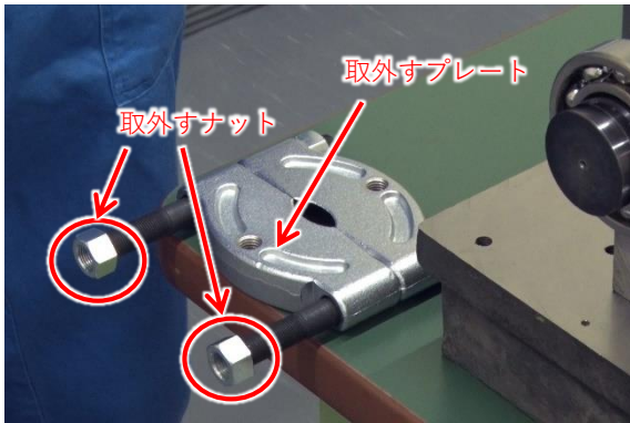
図 5.9 ナットの取外し
