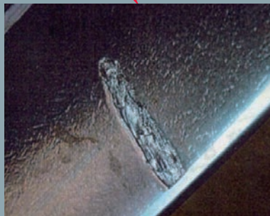
スポーリング (フレーキング、剥離)
