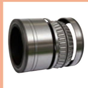
ULTAGE (アルテージ) シリーズ 圧延機ローレット用 密封形四列円すいころ軸受【CROULLタイプ】
