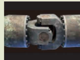
ユニバーサルジョイント 稼働後の状態
