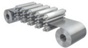
鉄鋼設備 (冷間圧延機)
