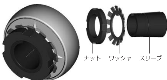
回転精度が要求される箇所 アダプタ方式
