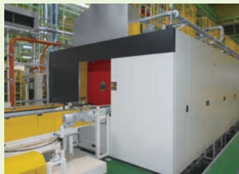
電気加熱式の真空浸炭炉 (日本：桑名製作所)
