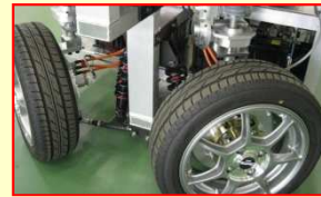
4輪独立駆動操舵システムを搭載した デモ車両Q'mo(キューモ)
