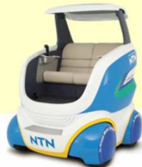
4輪独立駆動操舵システムを搭載した デモ車両Q'mo(キューモ)
