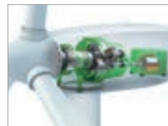
主軸、増速機、 発電機などの 回転を支える
