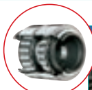
TGV鉄道車両用軸受* 外径：250mm
