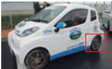
インホイールモータを搭載した二人乗り小型EV「ふじのくにEV・PHVタウン構想実験車」
