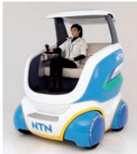
「4輪独立駆動操舵システム」を搭載したデモ車両「Q'mo」
