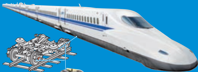
車軸用軸受 外径: 220mm
