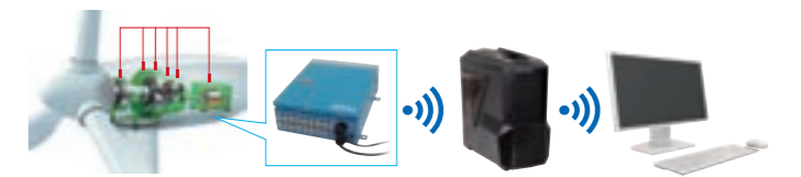
①風力発電装置内センサ + ②データ収集装置 + ③専用サーバ + ④解析・診断
