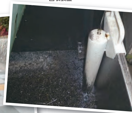
焼却灰をリサイクルした路盤材
