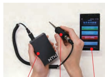
AD変換器 振動ピックアップ 振動測定器 (NTNが販売) スマートフォン (お客さまが準備)
