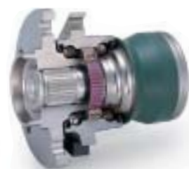
ワイヤレスABSセンサシステムの適用例
