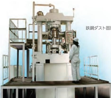
鉄鋼ダスト固形化装置
