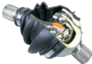
等速ジョイントとは、大きな角度でも滑らかに回転力を伝達する部品です。受賞商品は、世界初のステアリング用ボールタイプ等速ジョイントで、従来のステアリング用等速ジョイントに比べ、約50%の大幅な軽量・小型化に成功した点が評価されました。軽量・小型化によって自動車の環境負荷低減に貢献する商品です。
